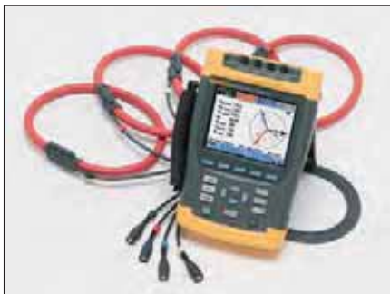
Fluke 435 con sondas flexibles
