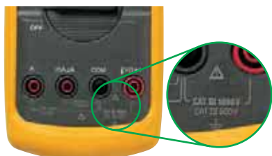
Utilice multímetros con las siguientes marcas: 1000 V CAT III ó 600 V CAT IV
