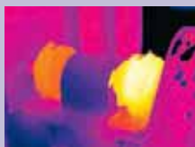
Sobrecalentamiento de rodamientos
